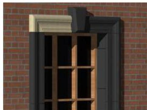
Левый элемент наличника - это вытянутый профиль наличника, который имеет в своей конструкции левый поворот профиля, направленный по периметру обрамления окна или двери.
